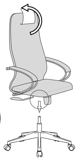
⚠ Для долгой и исправной работы газ-лифта после установки необходимо при помощи механизма поднять и опустить кресло в крайнее положение не менее 5 раз.
